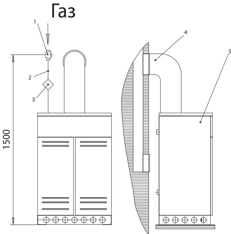
1 — газовый кран; 2 — газоподводящая труба; 3 — фильтр газа; 4 — дымоотводящая труба; 5 — аппарат
