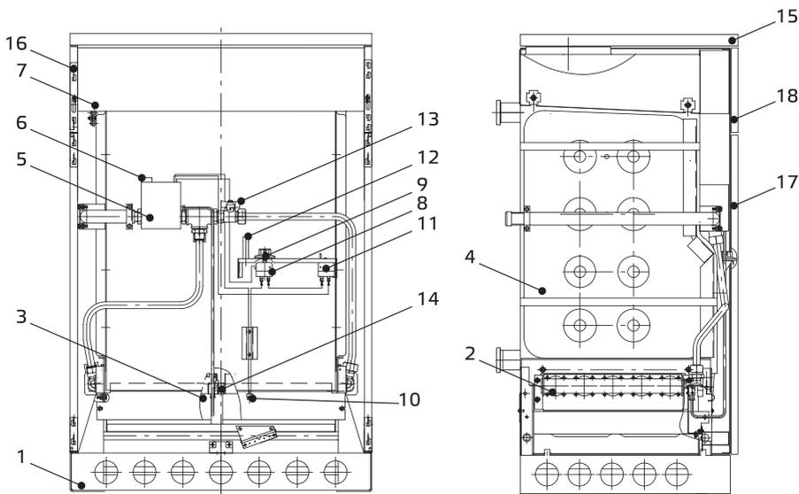
1 — рама; 2 — горелка основная; 3 — горелка запальная; 4 — теплообменник; 5 — блок газовый; 6 — ручка-указатель клапана газового магнитного; 7 — устройство газоотводящее; 8 — терморегулятор (термостат); 9 — ручка-указатель терморегулятора; 10 — предохранитель самовосстанавливающийся; 11 — термостат предельный; 12 — пьезорозжиг; 13 — кран; 14 — термогенератор; 15 — крышка; 16 — стенка боковая правая/левая; 17 — стенка передняя правая/левая; 18 — панель
