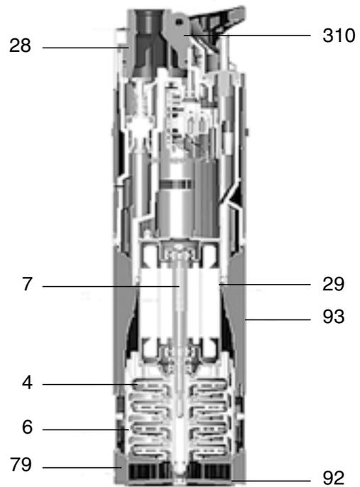
Рис. 50. Разрез установки SBA
