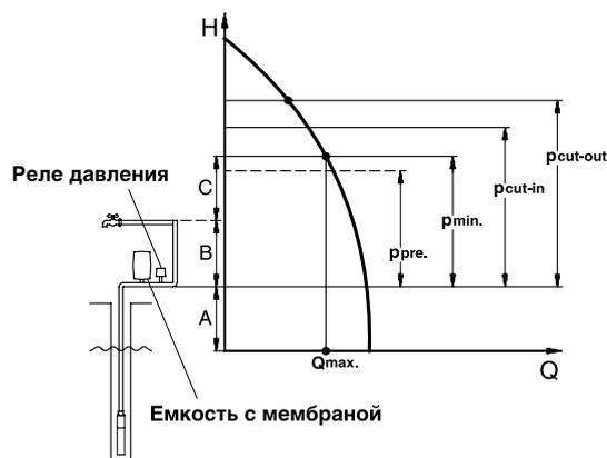
Рис. 27. Система с напорным гидробаком
