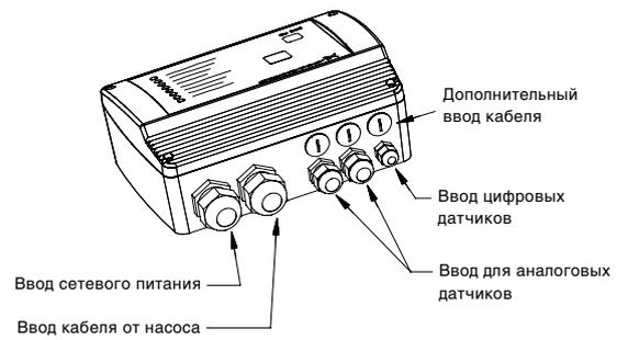
Рис. 18. Входы блока CU 300
