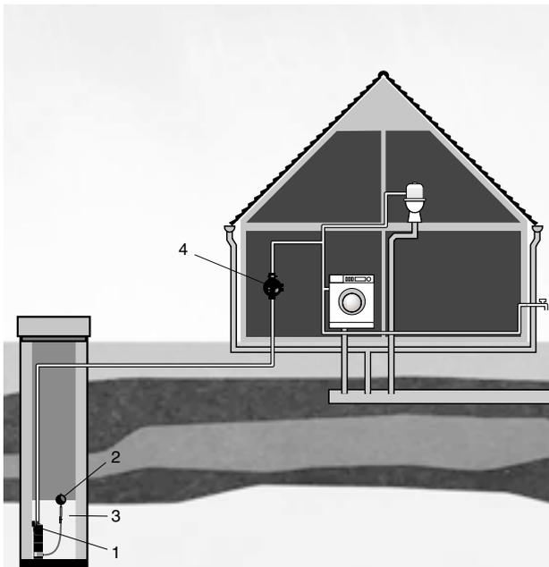
Рис. 49. Пример монтажа насосов SB с блоками автоматики PM 1/PM 2 в колодце
