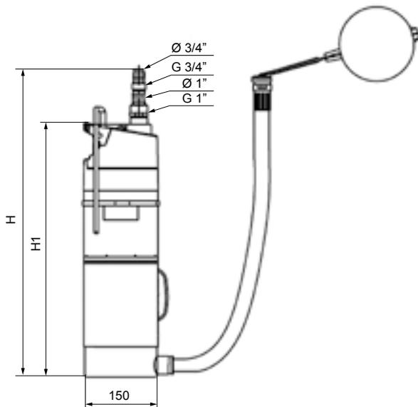
Рис. 54. Модель SBA с поплавковым сетчатым фильтром
