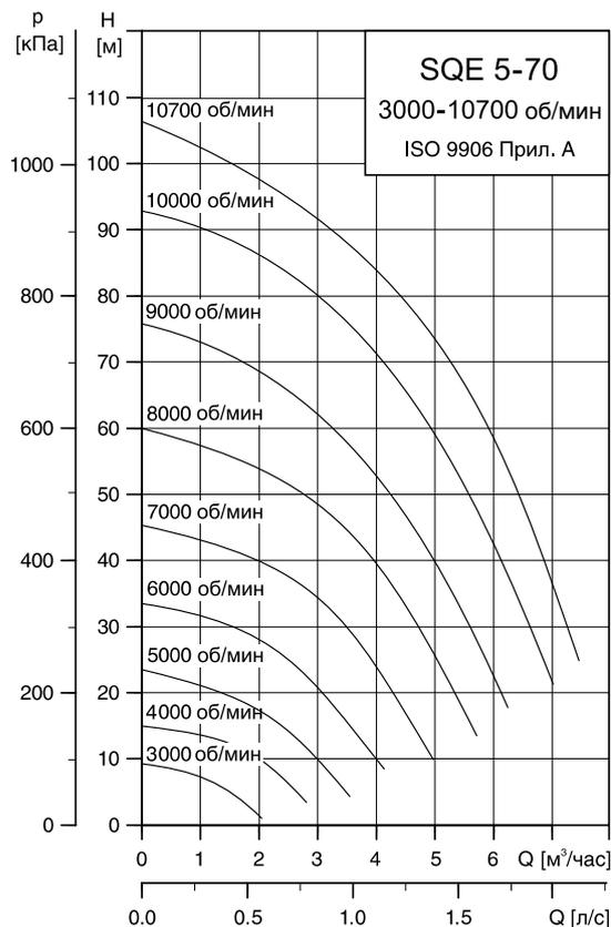
Рис. 25. Пример регулирования частоты вращения насоса SQE
