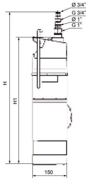
Рис. 52. Модель SBA со встроенным сетчатым фильтром
