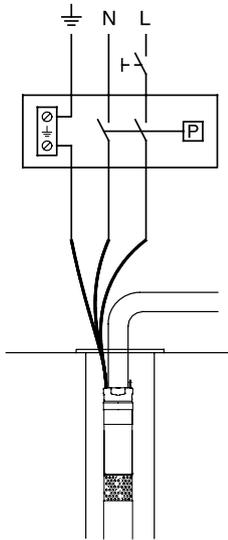
Рис. 29. Электросхема подключения насоса к сети
