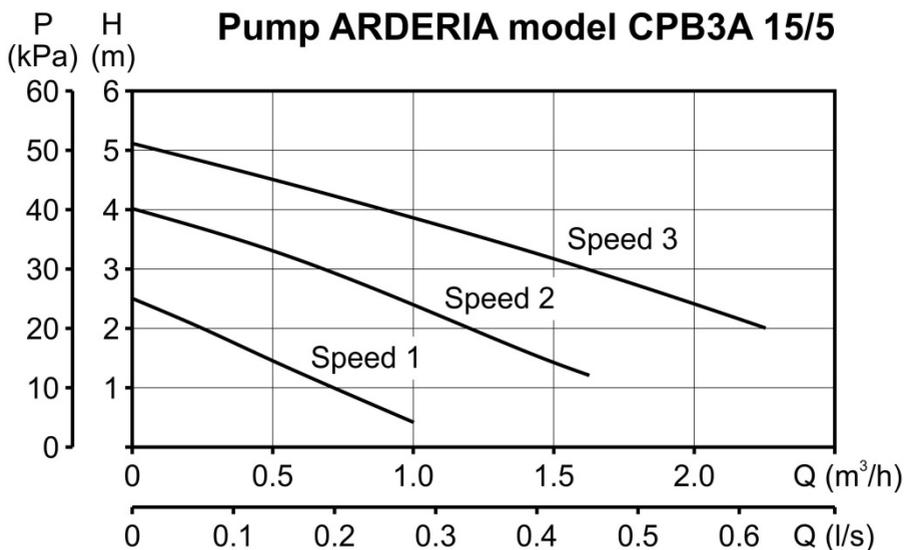
Рис. 5. Напорно-расходные кривые циркуляционного насоса котла.
