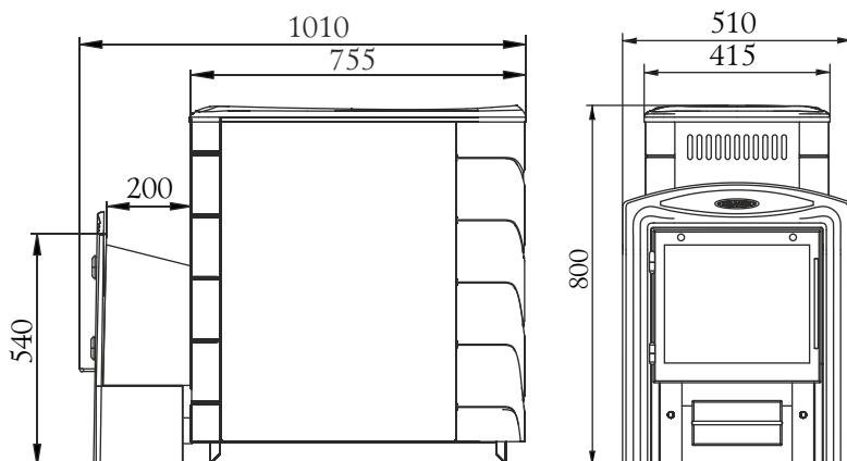
Рисунок 1. Габаритные размеры печи «Тунгуска XXL 2013 Витра»
