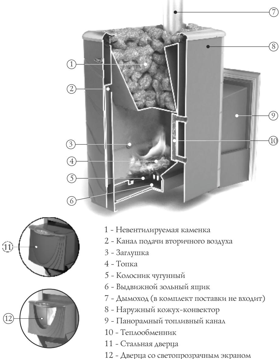
Рисунок 3. Расположение основных элементов печи «Тунгуска XXL 2013»
