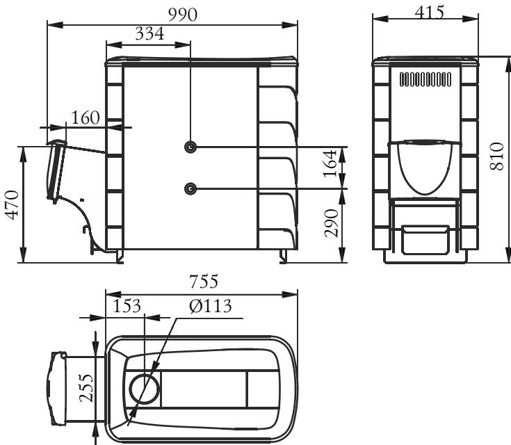
Рисунок 2. Габаритные размеры печи «Тунгуска XXL 2013».
